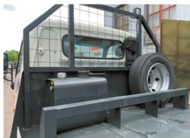
Защита гидробака и кабины
