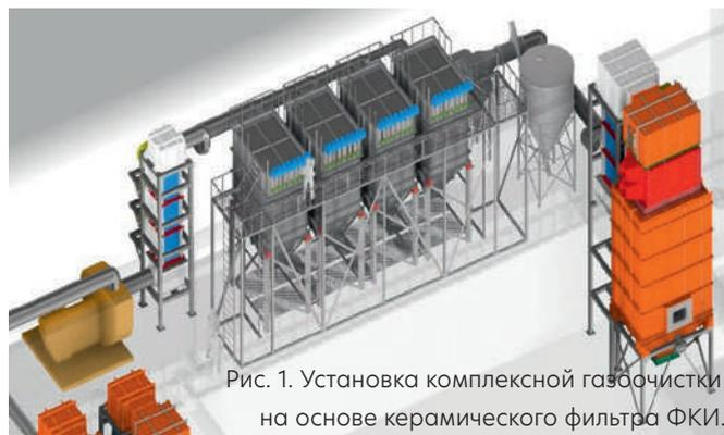
Рис. 1. Установка комплексной газоочистки на основе керамического фильтра ФКИ.
