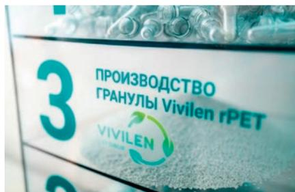
вторичного сырья в уже существовавшую на башкирском предприятии технологическую цепочку производства первичного ПЭТ. Гранула Vivilen rPET содержит до 25 – 30% повторно используемого полимера. Реализованный проект открывает окно возможностей для производителей упаковки, которых от использования вторичных полимеров удерживала необходимость инвестировать в дополнительное оборудование — Vivilen rPET этого не требует.
